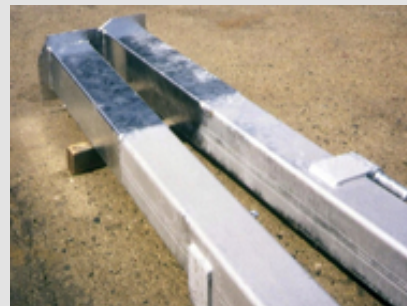
Abb. 5: Zusammengesetztes Bauteil mit unterschiedlich ausgeprägten Zinkschichten
