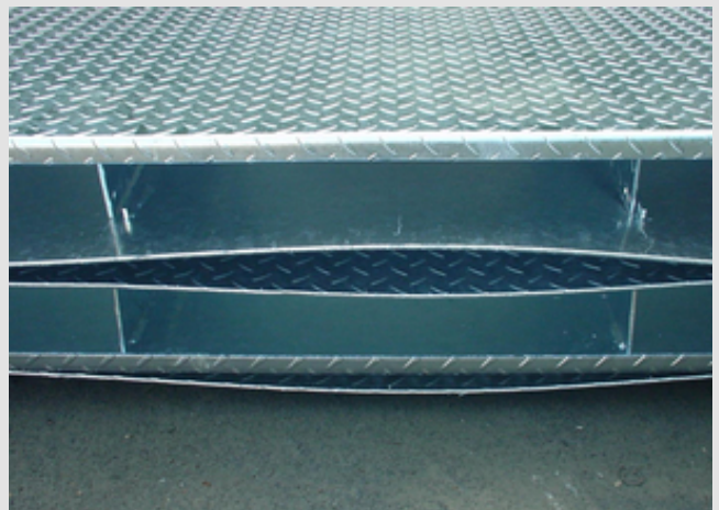
Abb. 2: Verzug an einem Bauteil durch Eigenspannungen
