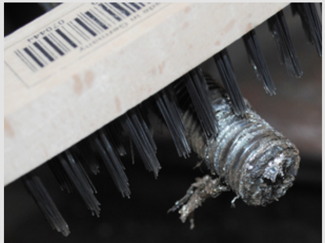
Abb. 2: Nach dem Feuerverzinken müssen die Gewebandrückstände beispielsweise mittels einer Drahtbürste entfernt werden.
